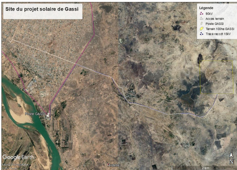
Figure b : Centrale Gassi et son raccordement
